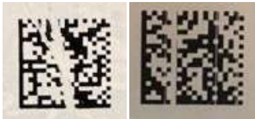
Нарушение целостности КМ*
