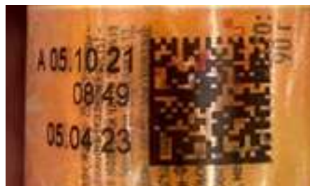
Печать кода маркировки на бликующей/светоотражающей поверхности
