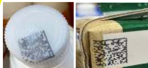
Смещение кода маркировки при печати
