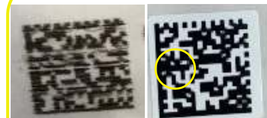
Смазывание кода маркировки или его отдельных элементов
